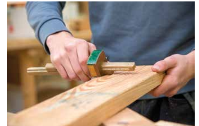
Het afschrijven van een maat met behulp van een kruishout.
