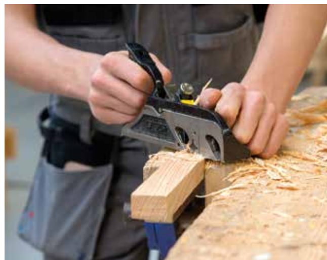
Het bewerken van een klamp met een sponningschaaf.
