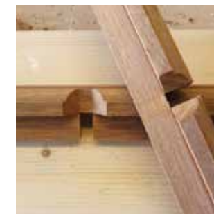
Het afschrijven van een maat met behulp van een kruishout.
