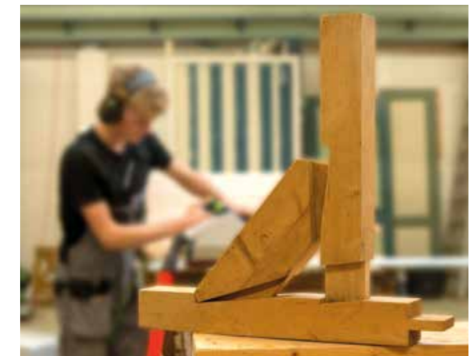
> Voorbeeld van een ankergebint met verschillende verbindingen: gesloten pen en gat met schuine borst aan korbeel en doorgestoken pen met loef aan ligger.
